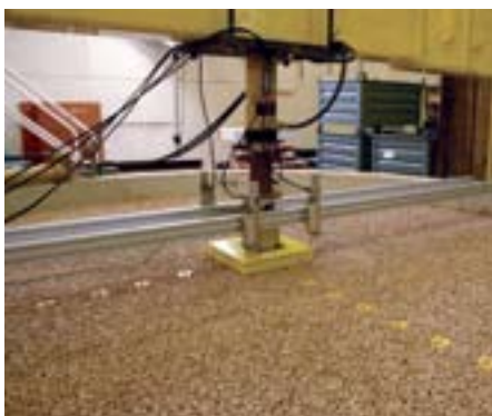
Testy únosnosti v BRE potvrdily, že použití geomříže TriAx zvyšuje úhel roznosu zatížení.
